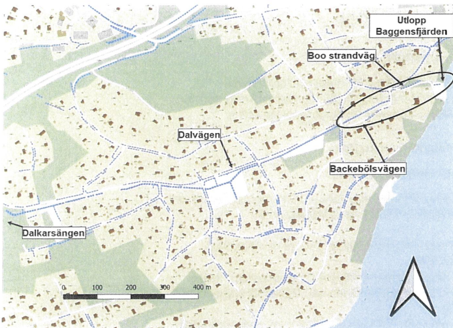
Figur 2. Befintligt dagvattensystem längs Backebölsvägen, Boo strandväg och uppströms liggande områden. Åtgärder som innebär vattenverksamhet görs inom den svarta ellipsen.
